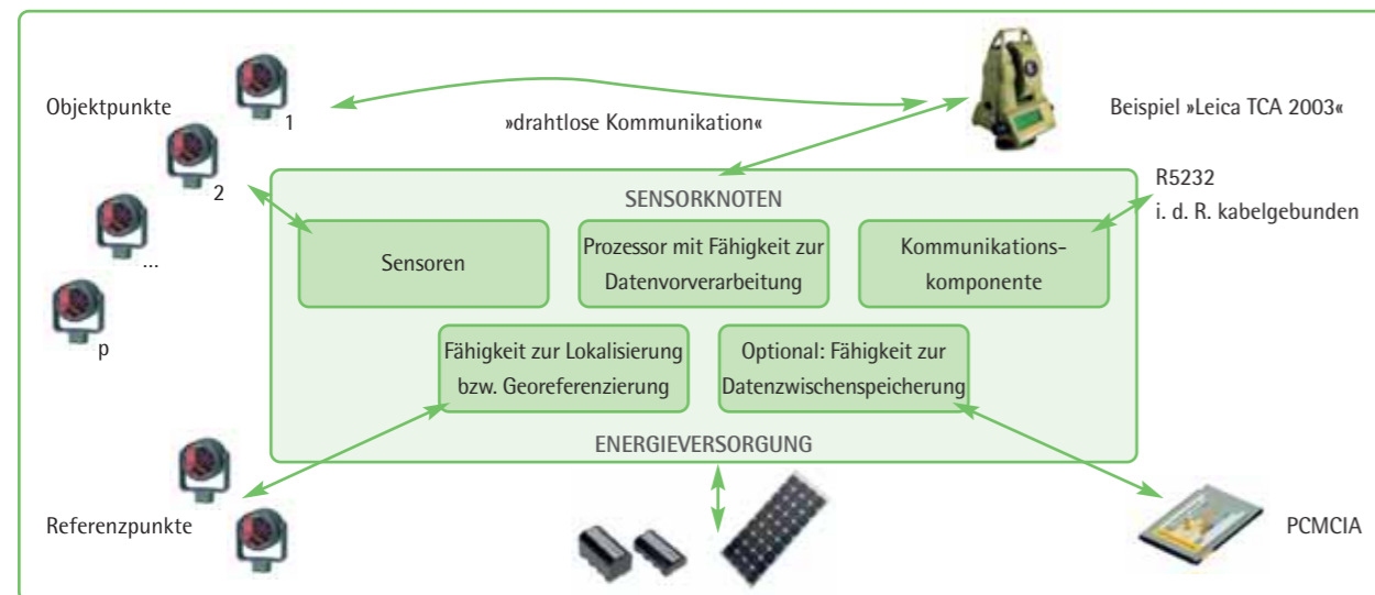
Abb. 3: Motorisiertes Tachymeter als Sensorknoten bei Überwachungsaufgaben
