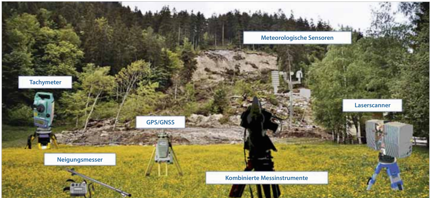
Abbildung 10 | Geodätische Sensoren mit lokaler Reichweite (mit freundlicher Genehmigung von Prof. Harald Schuh, GFZ Potsdam)
