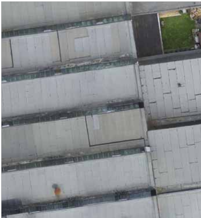
Abbildung 11 | Dachlandschaft als Orthofoto (Genauigkeit <\pm 1 mm), aufgenommen von einer Drohne
