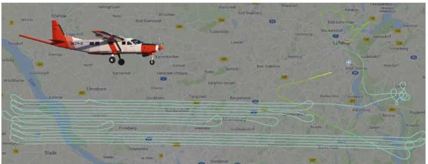
unten: Typisches Flugmuster eines Flugzeugs bei der Datenaufnahme
